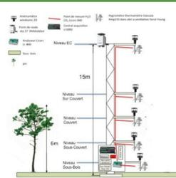
Schéma d'implantation des capteurs
