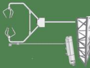
l'anémomètre sonique 3D HS-50 de Chez Gill Inst et de l'analyseur de Gaz infrarouge LI 7200 de type Closed Path de chez Licors. Les capteurs sont situés à une altitude de 15 m pour un azimut de 335° (direction des vents dominants). Le dispositif a été installé selon les préconisations décrites dans le protocole Icos Europe défini par Aubinet et Al. Les mesures sont acquises à une fréquence de 20 Hz sur une centrale d'acquisition CR3000 Campbell Sci et en parallèle sur l'interface LI-7550.
