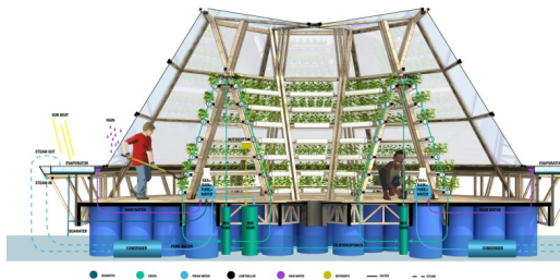
FIGURE 4. PROCÉDÉ DE DISTILLATION DE L'EAU DE MER DANS LES BACS
