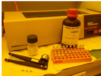
Figure 5 : Les échantillons sont repris avec l'acide phosphorique puis transférés dans un vial fermé avec un bouchon par l'intermédiaire d'une pince à sertir.
