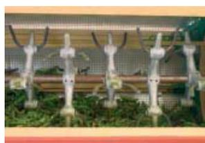
Le remplissage de la machine s'effectue par le haut. Après fermeture et mise en route, les pales séparent les cosses des pois en un temps record
