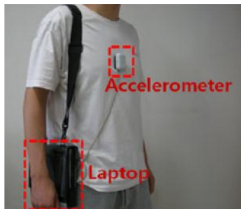
Figure 2-17 : Positions de l'accéléromètre et de l'ordinateur portable [LEE 11]
