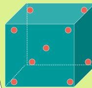
Emplacement des capteurs aux coins : distance des parois égale à 1/10<sup>ème</sup> de chacune des dimensions du volume intérieur (l, h, p).
