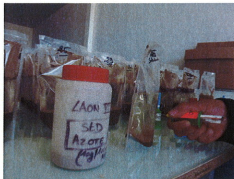
Figure 10 : Photographies des sachets, contenant du sol et de la solution de KCl et prélèvement du surnageant à la seringue, contenant l'azote minéral extrait du sol.
