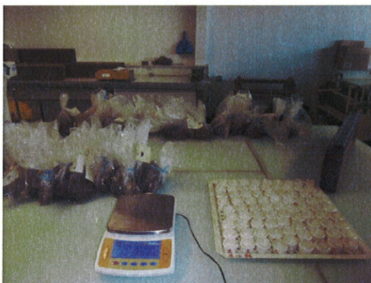
Figure 11 : Photographie du matériel utilisé pour déterminer l'humidité d'un sol
