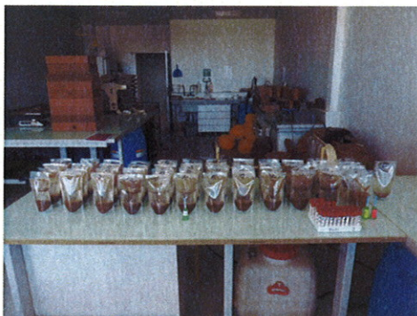
Figure 10 : Photographies des sachets, contenant du sol et de la solution de KCl et prélèvement du surnageant à la seringue, contenant l'azote minéral extrait du sol.
