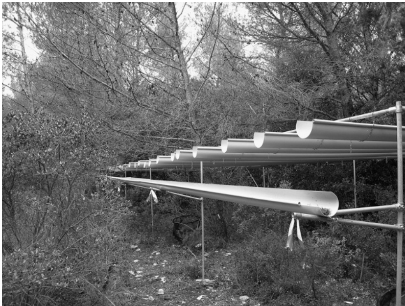
Photos 3 et 4 : Le site expérimental de Font-Blanche dans les Bouches-du-Rhône. Le système d'exclusion d'eau de pluie et Guillaume Simioni présentant l'automate de mesure de la respiration du sol. Photos DA et Naama TESSLER
