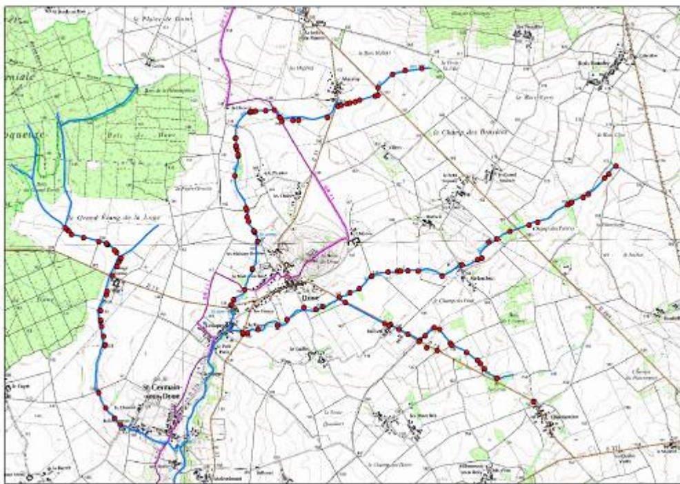
Figure 5.6 : Extrait de la carte de l'Orgeval (branche Est, Ru des Avenelles) localisant les 150 exutoires de drainage.
