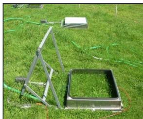
Chambres automatiques pour N<sub>2</sub>O protoxyde d'azote
