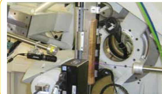
Figure 2 Photographie d'un échantillon positionné sur la table à translation de la ligne DIFFABS.
