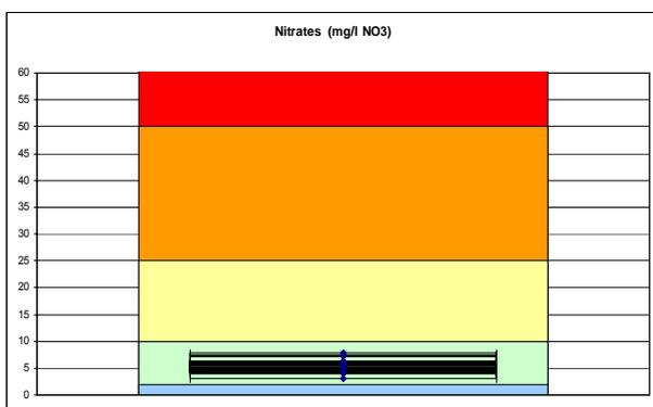
Les concentrations en NO<sub>3</sub> ne présentent aucun déclassement et sont conformes aux objectifs de la DCE pour 100% du temps.
