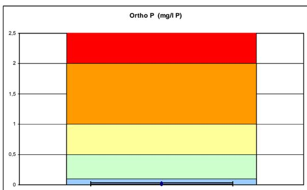
Les concentrations en PO<sub>4</sub> ne présentent aucun déclassement et sont conformes aux objectifs de la DCE pour 100% du temps.
