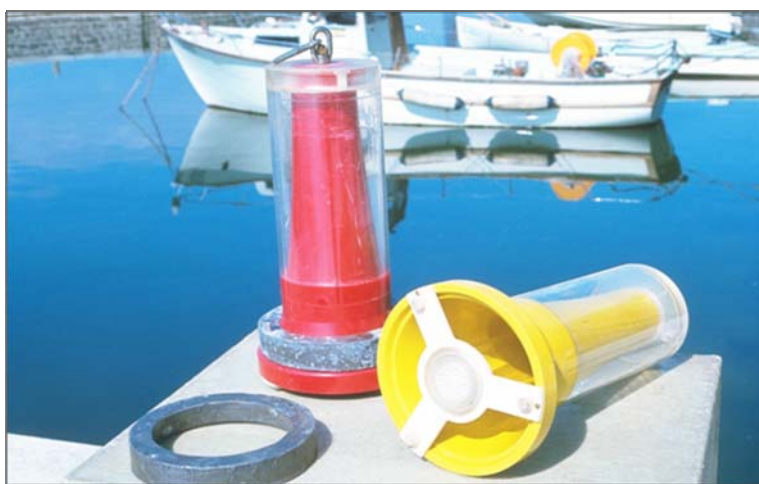
Photo 1 Appareil intégrateur collecteur du phytoplancton
