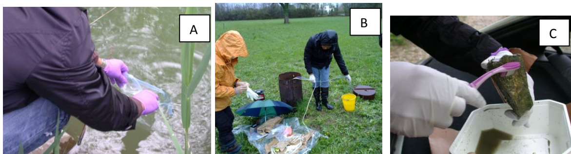
Figure 8 : Photos des prélèvements d'eau et de biofilms épilithes. A, eau en surface, B, eau dans les nappes où une pompe stérilisée est immergée dans la nappe grâce au puits de forage et où l'eau est remontée par un tuyau stérile avant d'être stockée dans un sac zippé stérile étanche, C, biofilm épilithe gratté sur une pierre prélevée en bordure de canal.
