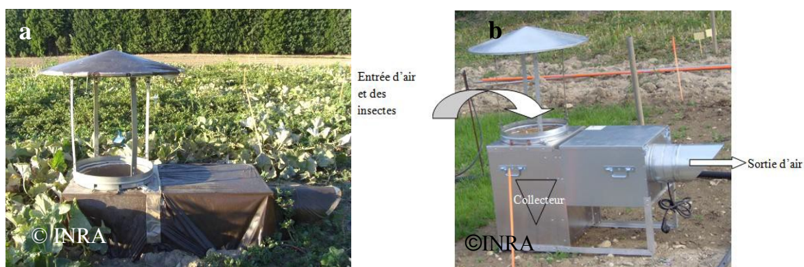
Figure 9 : a) Piège à suction installé dans la parcelle ; b) Principe de fonctionnement du piège à suction
