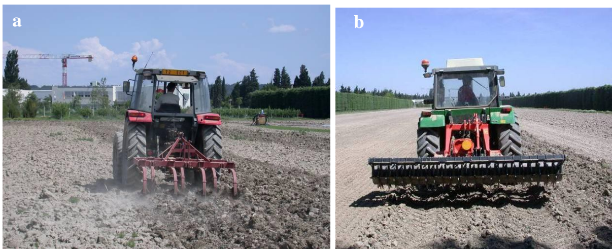
Figure A4-1 : Travail du sol à l'aide du chisel (a) et de la herse rotative (b)
