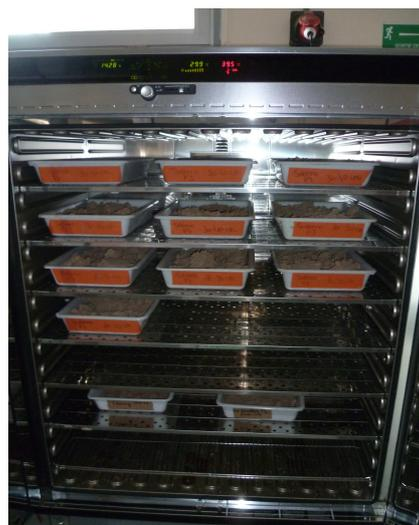
Photo 3 : Etuve à 30°C avec échantillons de sol.
