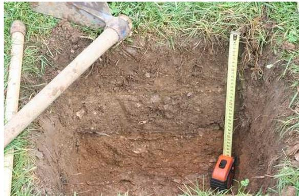
Photo 2 : Fausse de prélèvement de 40cm de profondeur.
