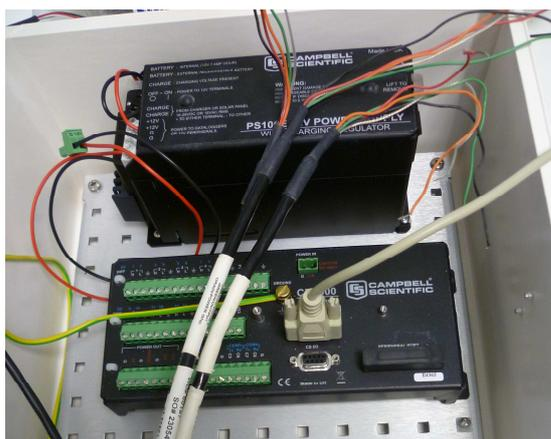
Photo 1 : Centrale d'acquisition CR1000 et batterie.
