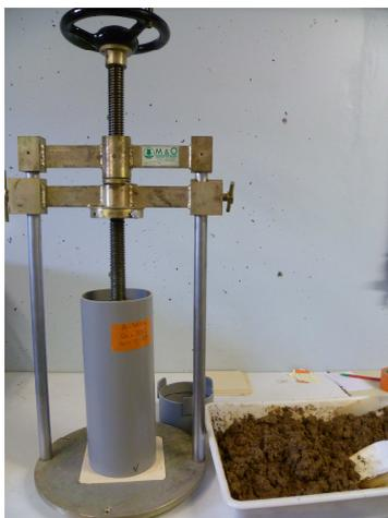
**Photo 6 : Presse manuelle pour la fabrication des colonnes.**
