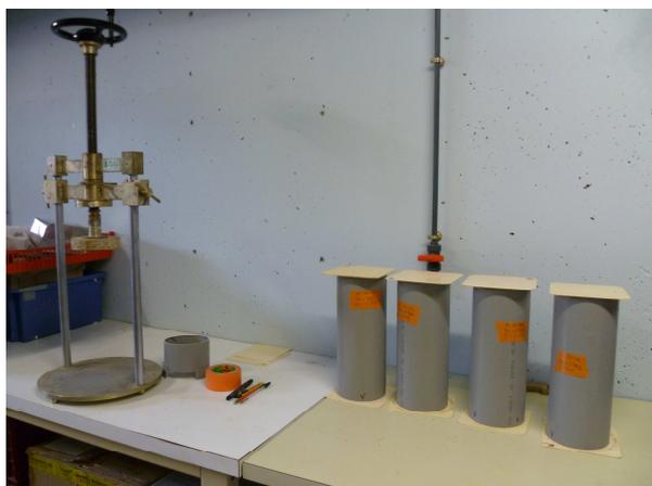
**Photo 7 : Presse manuelle et colonnes de sol.**
