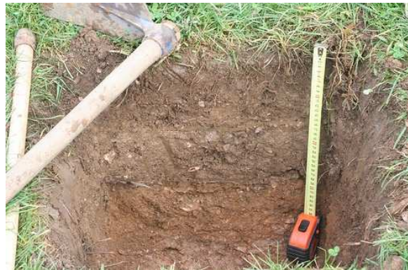
Photo 2 : Fausse de prélèvement de 40cm de profondeur.
