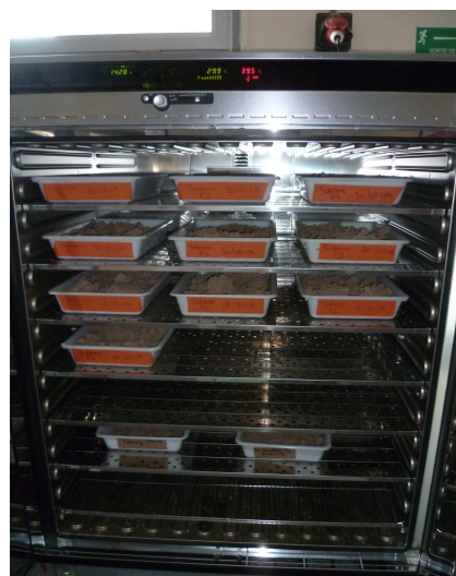
Photo 3 : Etuve à 30°C avec échantillons de sol.
