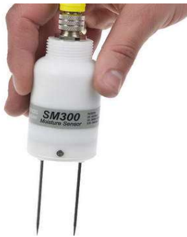
Figure 8 : Sonde SM300, mesure deux paramètres : teneur en eau volumique et température.
