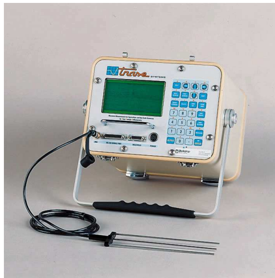
Figure 11 : Appareil Trase de Soil Moisture avec sa sonde TDR.
