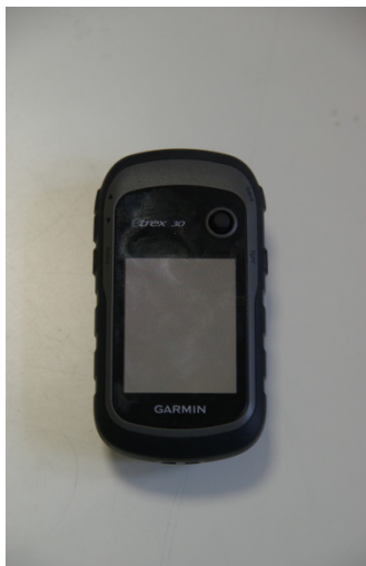
Figure : Photographie du GPS Garmin utilisé pour les relevés terrains
