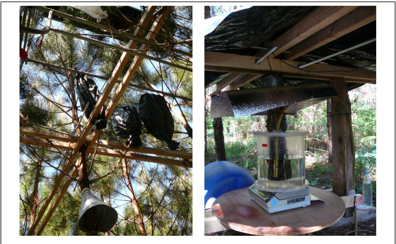
Photo 2 : Potomètre mis en place à l'issue de la première journée de cinétique flux-potential, pour distinguer les parts respectives de la résistance du tronc et des racines. La photo de gauche rend compte de la charpente utilisée pour maintenir l'arbre en place ; celle de droite du bac d'eau alimentant la base du tronc. On distingue également la balance dont les mesures ont servi à étalonner le capteur de flux de sève.
