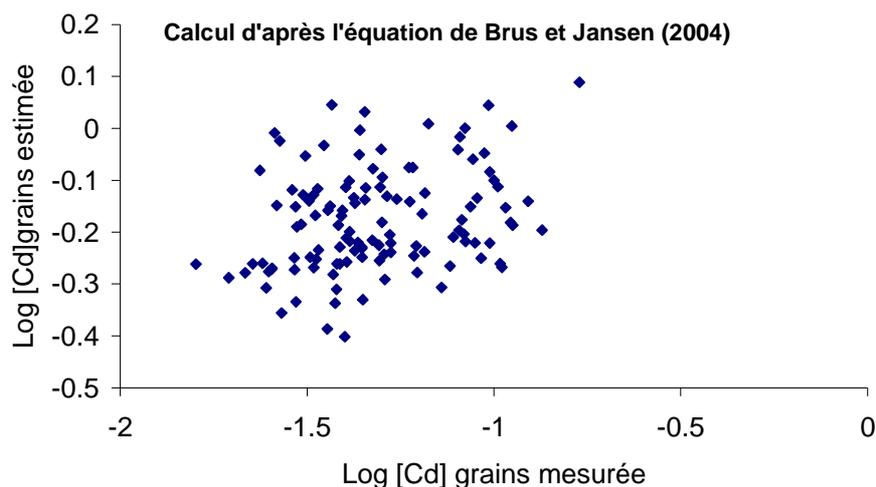
**Figure 2 : Comparaison entre les teneurs en cadmium dans le grain de blé mesurées lors de l'étude QUASAR (Sappin-Didier et al., 2002) et les teneurs calculées grâce à l'équation de Brus et Jansen ( $\text{Log [Cd]}_{\text{grain}} = 0.086 - 0.126 \text{ pH} - 0.218 \log (\text{MO}_{\text{sol}} \%) + 0.542 \log (\text{argile} \%)$ ) à partir des données mesurées sur les sols. Les teneurs en Cd sont exprimées en mg/kg MS.**
