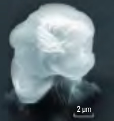
Tête de femme aux cheveux obtenue par microfabrication tridimensionnelle.
