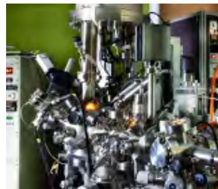
Grâce à cet appareil, on peut appliquer un vide poussé à des échantillons pour des applications spatiales, ou injecter des gaz pour étudier les effets de l'environnement sur le frottement.
