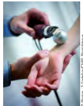
Mesure de la douceur de la peau avec une sonde triboacoustique (brevet CNRS).
