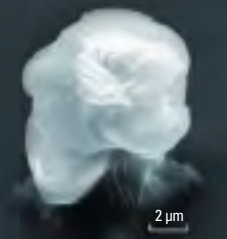
Tête de femme aux cheveux en bandeaux obtenue par microfabrication tridimensionnelle.
