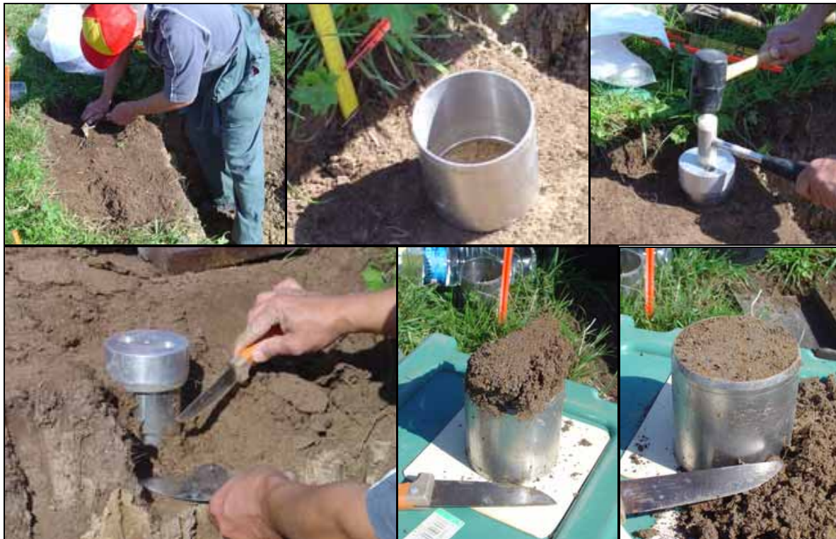
Prélèvement d'échantillons volumétriques avec la méthode du cylindre
