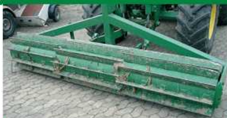
Le rouleau faca, écraseur de végétaux, est utilisé pour la destruction économe en énergie de couverts intercultures.
