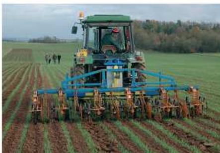
Désherbage mécanique d'une parcelle de seigle au stade trois feuilles, avec une bineuse munie d'un appareil de guidage à cellules photo-électriques (09/11/07).
