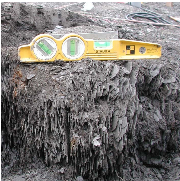
Figure 14 : photographie représentant un bloc, et le sens de sa schistosité très prononcée.
