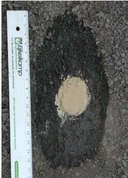
Figure 13 : photographie représentant la diffusion de l'eau en surface lors d'un essai d'infiltrométrie.
