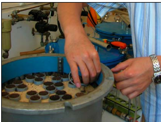
Photo n°5 : Connexion du capillaire pour évacuation de l'eau
