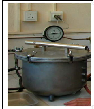
photo n° 1 : Chambre à pression de RICHARDS du laboratoire sol de l'unité EMMAH (INRA Avignon) et plaque en céramique
