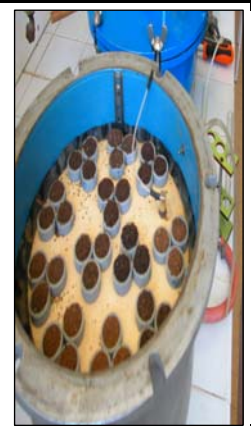
Photo n° 4 : Mise de la plaque dans la chambre
