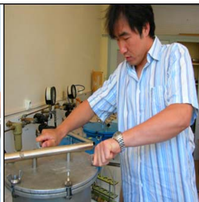
Photo n°6 : Fermeture de la chambre avec les boulons
