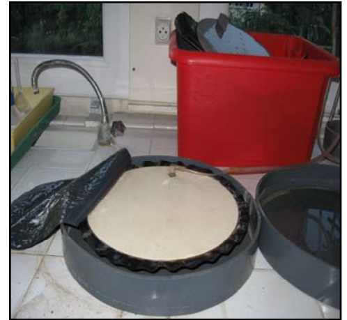
Photo n° 2 : Mise en saturation des plaques
