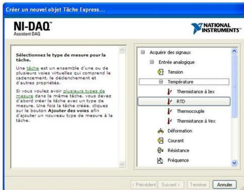
Pour connecter la sonde pt100 à l'ordinateur, il faut ajouter un assistant DAQ au programme et le paramétrer de façon à acquérir une température.
