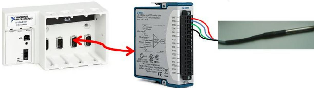
La connexion physique de la sonde Pt100 se fait de la façon suivante : la sonde est reliée au NI 9217 qui est lui-même relié à l'interface NI CompactDaq ; on câble ce dernier à l'ordinateur via un câble USB.
