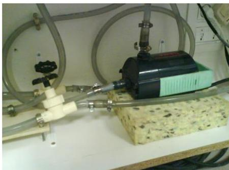
La pompe permet la bonne circulation de l'eau dans le système. Elle est alimentée en 220V et est connectée directement sur le secteur.
