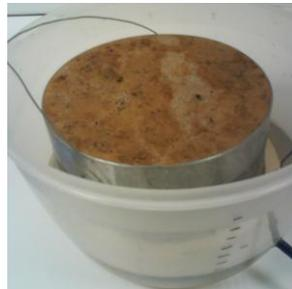
La conservation de l'échantillon humide se fait dans des récipients hermétiques et à 4°C (limitation de l'activité biologique). La saturation de l'échantillon est ensuite réalisée au laboratoire.
