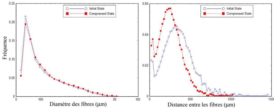
**Figure 4 :** Distributions des tailles des fibres (à gauche) et des tailles des pores (ou distances inter-fibres, à droite)
