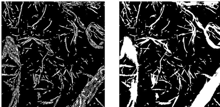
**Figure 3** : Images binaires d'une coupe parallèle aux faces avant rebouchage (à gauche) et après rebouchage (à droite) des fibres. Taille 5 × 5 mm<sup>2</sup>.
