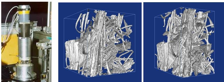
**Figure 1.** *Essais de compression sous imagerie X*
