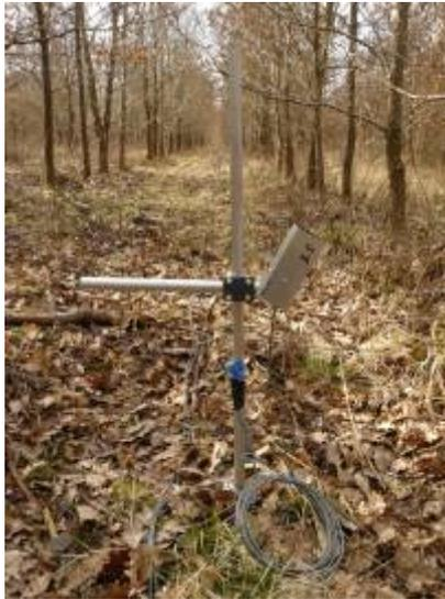
1 capteur de PAR transmis par PU
