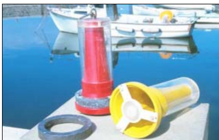
Photo 1 Appareil intégrateur collecteur du phytoplancton
