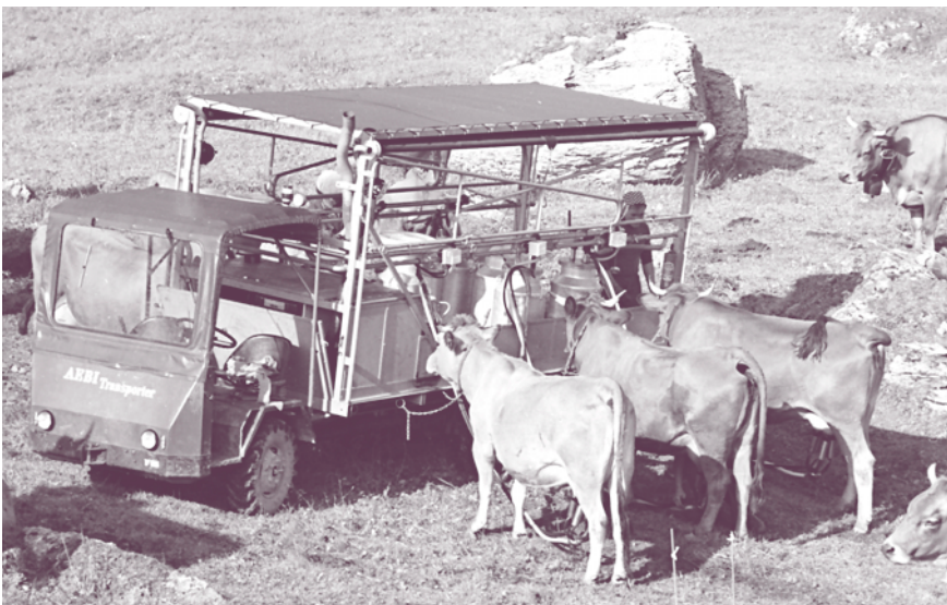
Le premier prototype de machine à traire (Tarine) en alpage (atelier INRA-Jouy-en-Josas).
