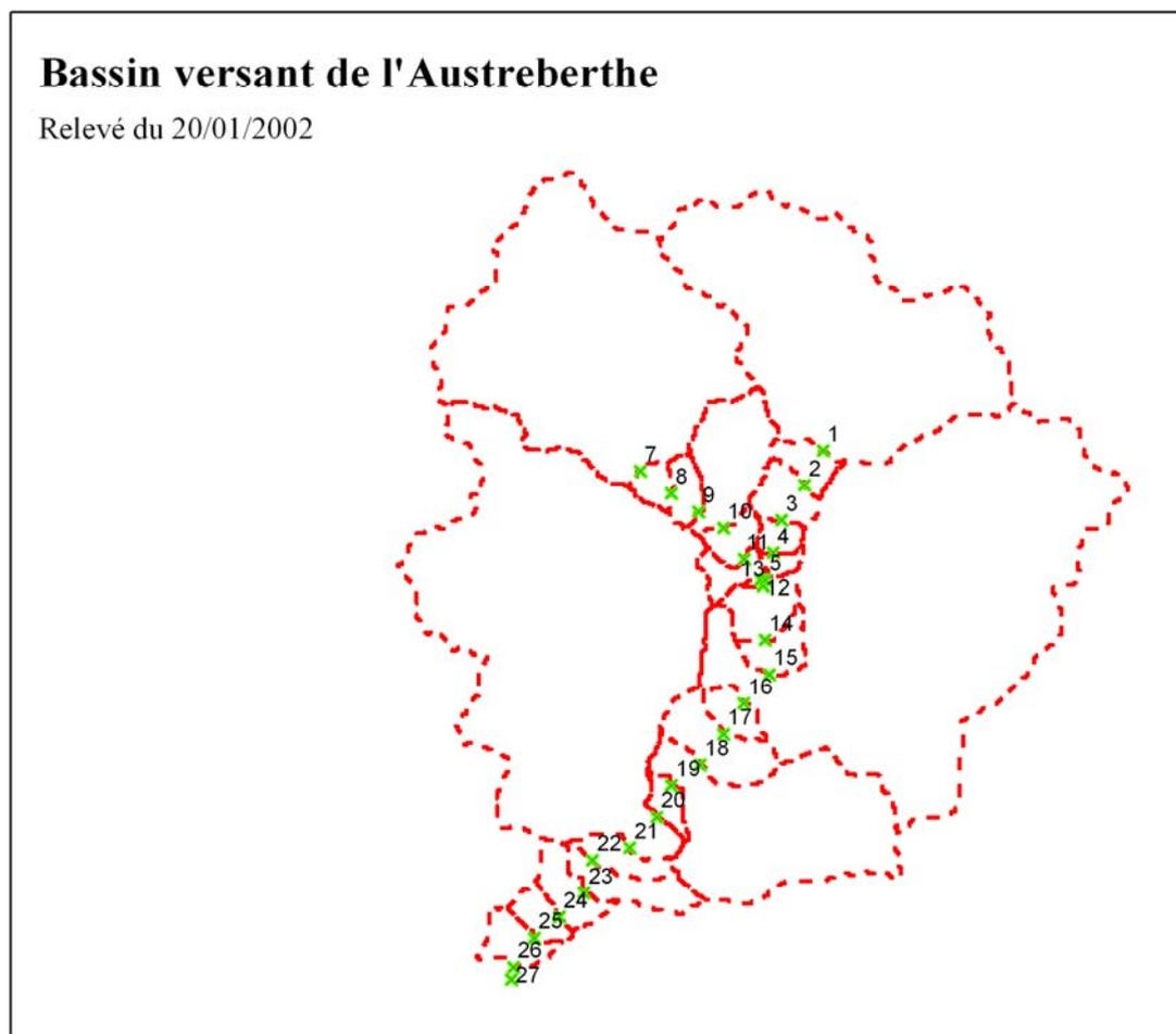
Figure 9 : découpage du réseau hydrologique en tronçons kilométriques pour lesquels les bilans de ruissellement et de perte en terre sont calculés.
