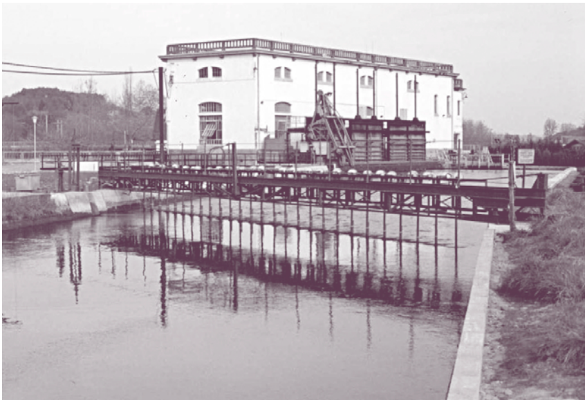
Essai d'un écran électrique de descente dans le canal d'aménée de l'usine hydroélectrique d'Halsou sur la Nive, 1996.
