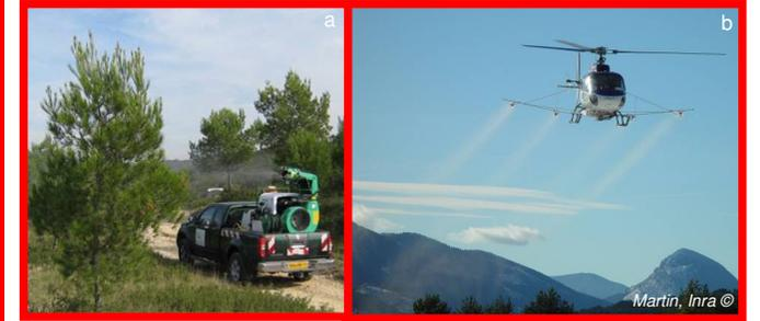
a : Traitement chimique réalisé à l'aide d'un canon, b : Traitement chimique aérien
