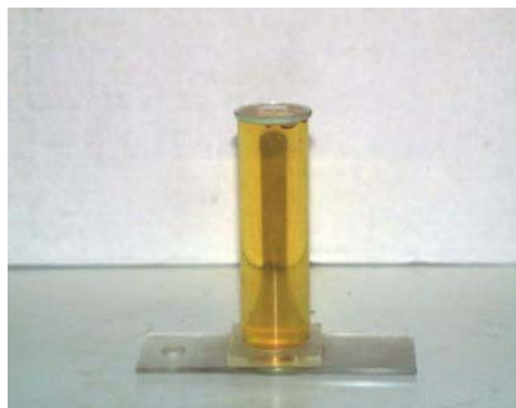
Photo II.3 : Chambre de sédimentation (Photo A. Rolland)
