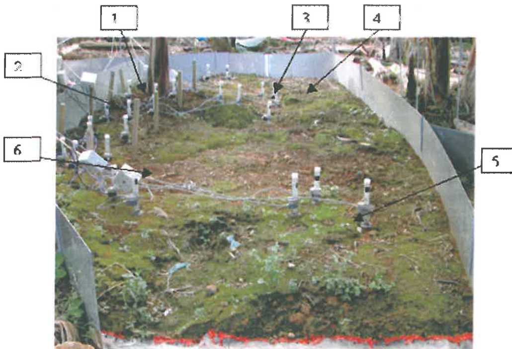
Figure 9 : Emplacements des mesures d'infiltrométrie
