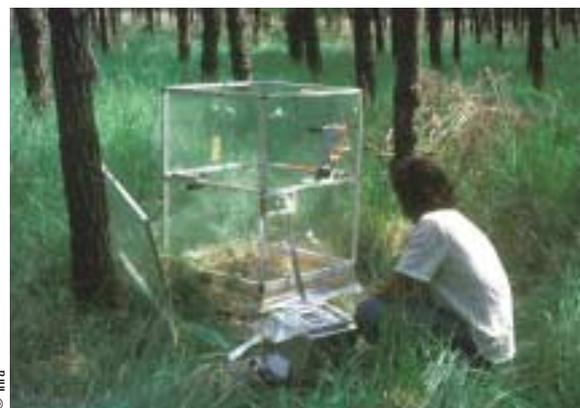
▲ Chambre de mesure des flux de chaleur et de vapeur d'eau sous étage d'une forêt de pins maritimes.
