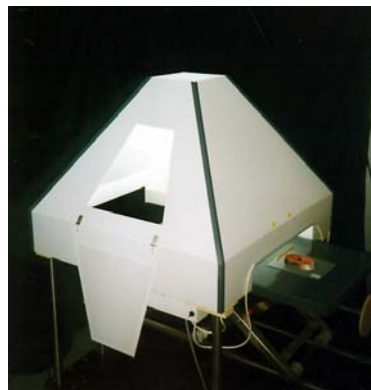
Figure 21 : Système d'éclairage du système de vision numérique couleur
