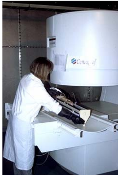
Figure 8 : Imageur Siemens Magnetom Open 0,2 T utilisé dans le cadre du programme.
