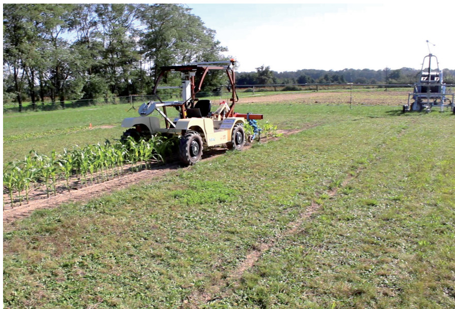
Étude d'un tracteur électrique robotisé pour l'agroécologie. © INRAE
