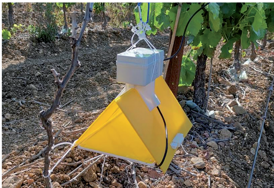
Piège à insectes connecté. © Le mas numérique.
