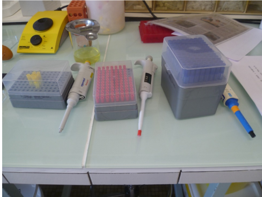
Annexe 4 : 3 types de pipettes. J'ai utilisé la pipette bleue de volume 200 \mu l à 1000 \mu l.
