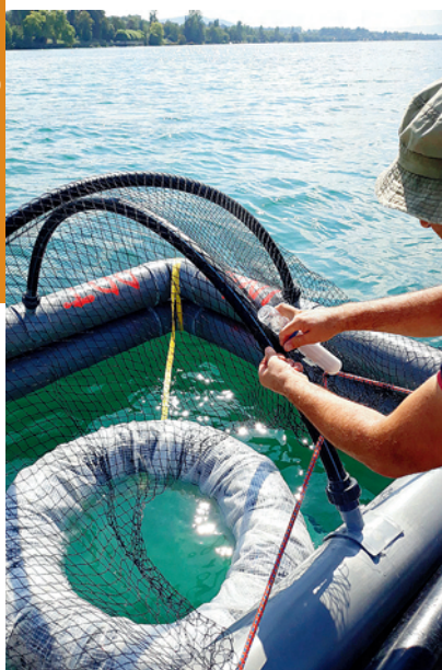
Laurent Espinat, qui a pensé et fabriqué la structure flottante, pose un feu de signalement pour la rendre visible de nuit
