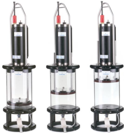
Figure 1 Photographies de la bouteille intégratrice IWS avec le piston observé dans différentes positions. Le volume maximum pouvant être prélevé est de 5 litres.
