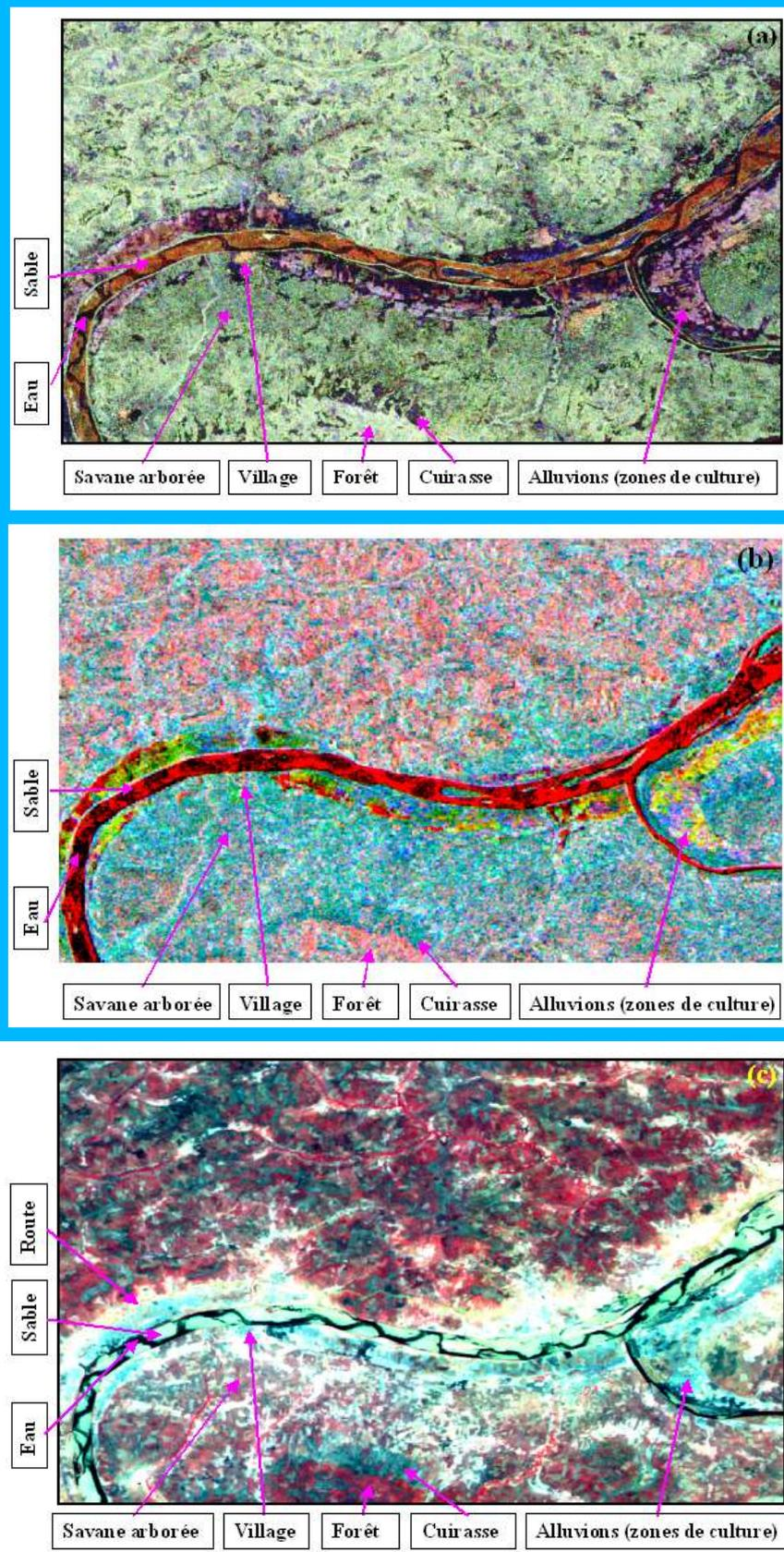
**Figure 5 :** (a) Image SIR-C acquise en avril 1994 avec LHH en rouge, LHV en vert et CHV en bleu. (b) Composition de trois images ERS avec celle du 08/06/1997 en rouge, celle du 20/08/1993 en vert et celle du 21/08/1994 en bleu. (c) Image SPOT acquise en mars 1998 avec le canal proche infrarouge en rouge, le canal rouge en vert et le canal vert en bleu. Le centre des images correspond à 9,3°W et 11,1°N. La taille des images est 18,3km (dimension horizontale) par 12,3km (dimension verticale).
