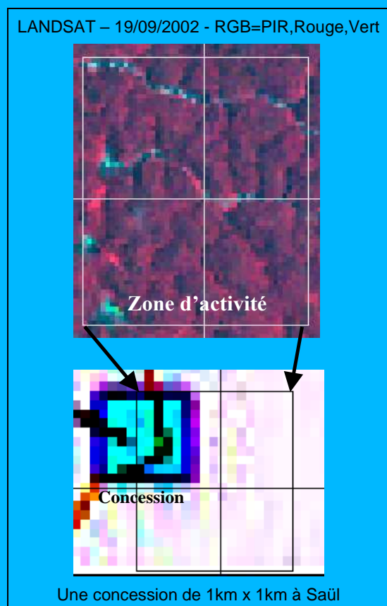
Figure 10 : Exemple de contrôle d'une concession légale dans la région de Saül (S2). La comparaison entre l'imagerie satellitaire et la carte des permis montre que la zone exploitée est bien supérieure à celle autorisée (en cyan-bleu).
