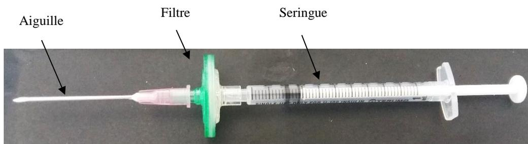
Figure 5 : Montage du procédé de filtration de la phase liquide du prélèvement après centrifugation
