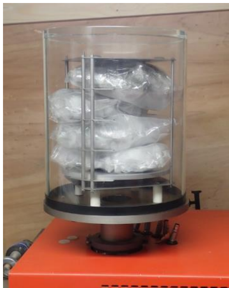
Figure 55 - Lyophilisation d'échantillons congelés en préalable au dosage des tanins condensés (crédit photo : INRA Lusignan)
