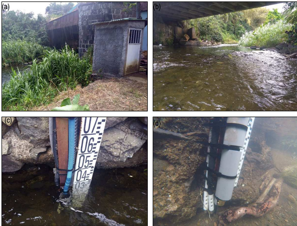
Figure 4 - Abri regroupant la centrale d'acquisition des données et le préleveur (a), Section de l'étalonnage de la rivière sous le pont (b), Echelle limnimétrique et arrivée des capteurs (c), Zone de mesure et de prélèvement (capteur de pression, crépine du préleveur) (d)
