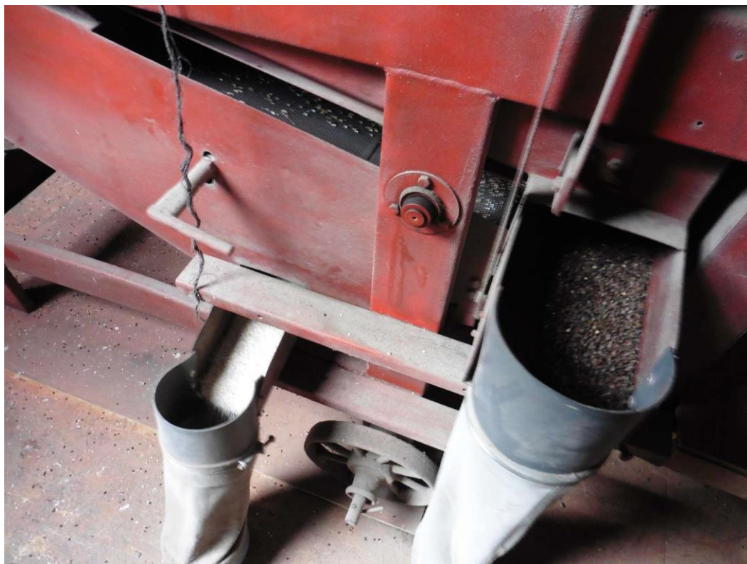
Deuxième étape de tri mécanique par grilles mobiles
