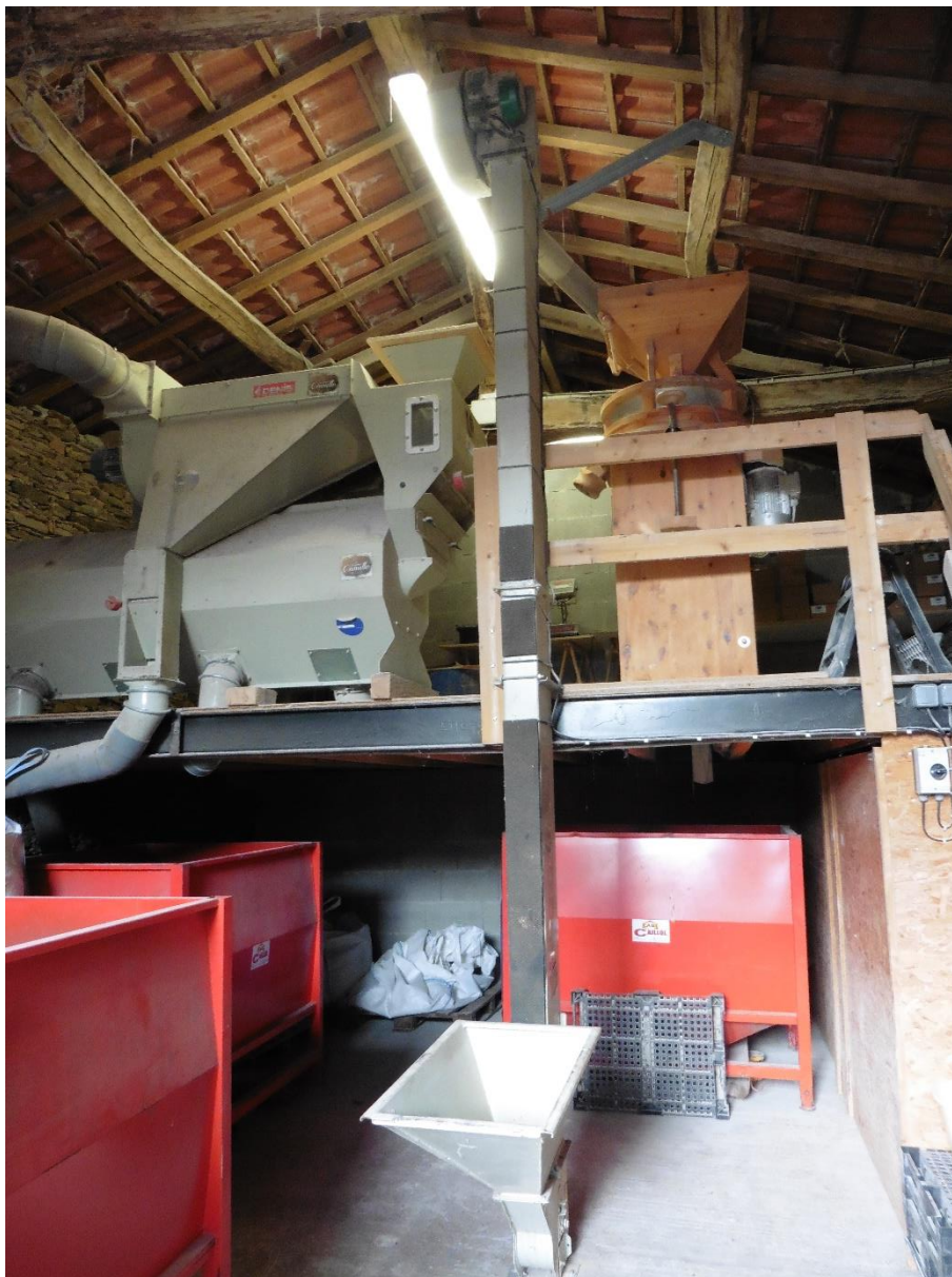
Le monte-charge (au milieu), le trieur mécanique (en haut à gauche) et le moulin (en haut à droite)
